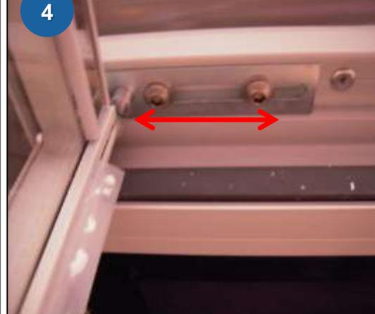
Um die Türen einzustellen, verwenden Sie die obere Scharnierplatte, indem Sie die 2 Schrauben lösen und dann die Tür bewegen
